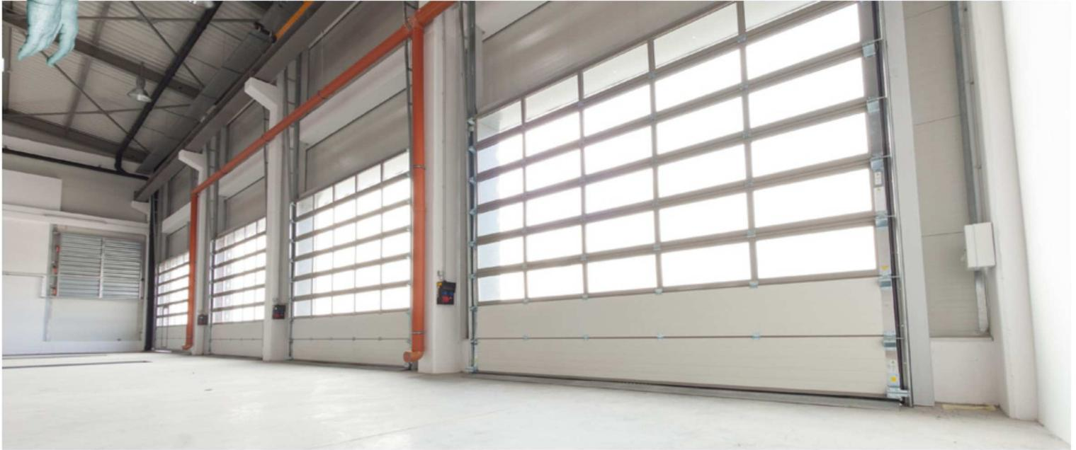
Materialele folosite pentru producerea ușilor secționale industriale sunt de cea mai bună calitate: panouri tip sandwich din tablă de oțel galvanizată vopsită, șine de culisare, accesorii din tablă de oțel galvanizată, role de culisare din oțel inoxidabil, chedere EPDM și profile din aluminiu extrudat. La panourile RIB, tabla are grosimea de 0,5 mm, iar la panourile Flush tabla are grosimea de 0,7 mm.
