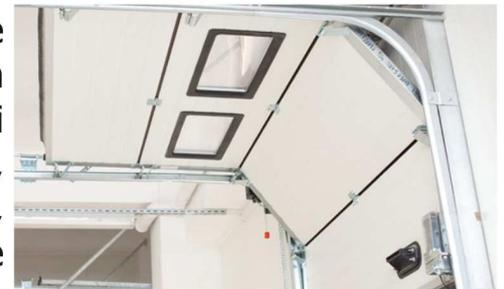
Pentru protecție sunt folosite elemente speciale: dispozitivul de siguranță în cazul ruperii arcurilor și căderii ușii, dispozitivul de siguranță în cazul ruperii cablurilor și căderii ușii, iar pentru varianta de acționare automată, fotocelule, motor cu protecție la întâlnirea obstacolelor sau senzor de presiune în garnitura inferioară (Safety Edged).
